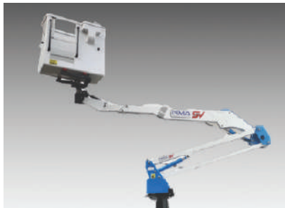
หลักคุณภาพสูงตรงแนยยกส่วนที่ 1, 2 และ 3 สามารถยืด หดได้
